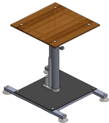
Gambar 4. Desain Meja Ragum Kerja Bangku Usulan
