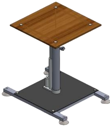
Gambar 4. Desain Meja Ragum Kerja Bangku Usulan
