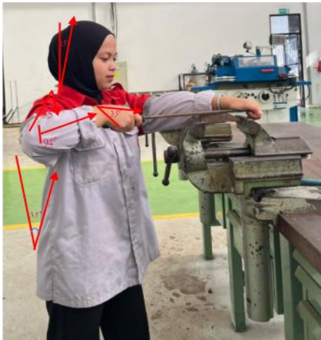
Gambar 3. Aktivitas Kerja Bangku Meja Ragam Eksisting
