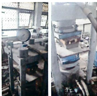
Gambar 2. Dokumentasi Uji Tekan pada Paving block
