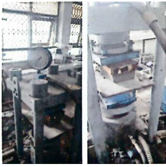
Gambar 2. Dokumentasi Uji Tekan pada Paving block
